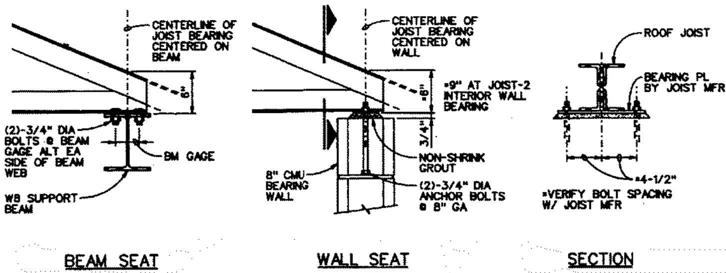
**JOIST BEARING DETAIL** 2
